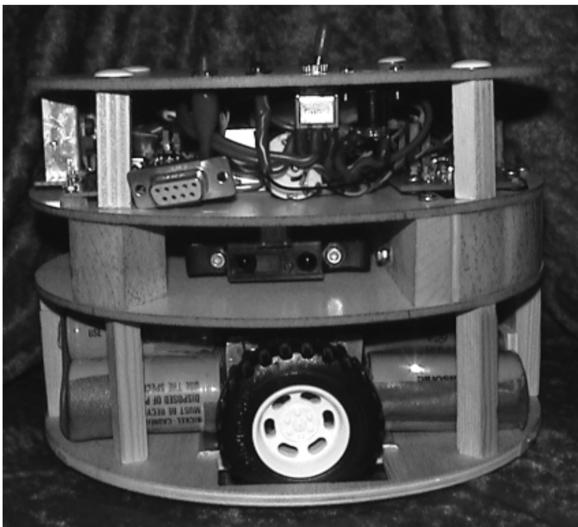
Abbildung 9: Seitenansicht des Roboters (ohne Verkleidung)
